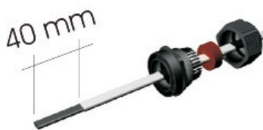
Dénuder la gaine isolante primaire sur une longueur maximale de 40 mm,
