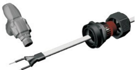
Enfiler les gaines thermo-rétractables 12/4 et à l'aide d'un générateur d'air chaud assurer leur retreint
